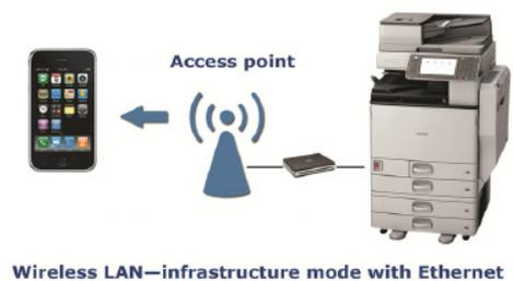
**Nota:** Es necesario tener instalada la opción de LAN inalámbrica Ricoh en la impresora o MFP para todas las configuraciones de LAN inalámbrica, ya sean ad-hoc o utilicen el modo infraestructura.
